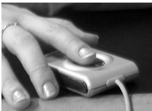
Figura 2 - Leitor biométrico de impressões digitais
